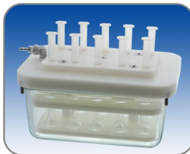
Manifold에 연결하여 아세트니트릴 5ml로 추출
